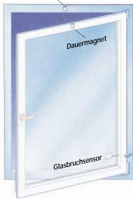
Außenhautüberwachung: elektronische Überwachung eines Fensters
